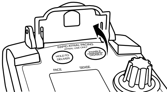
Рисунок 32. Элементы управления быстрой предсердной стимуляцией
