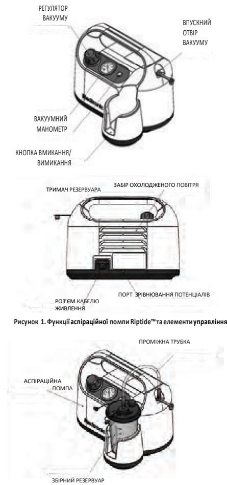
Рисунок 1. Функції аспіраційної помпи Riptide™ та елементи управління
